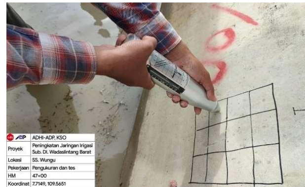
Gambar 4. Titik pengambilan hammer test
