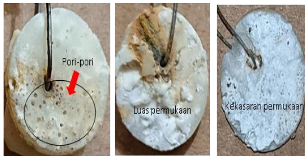
Gambar 4. Fenomena degradasi permukaan pada spesimen biokomposit
