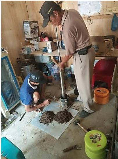
**Gambar 14.** Pengujian *Proctor Standard* secara mandiri di laboratorium penyedia jasa
