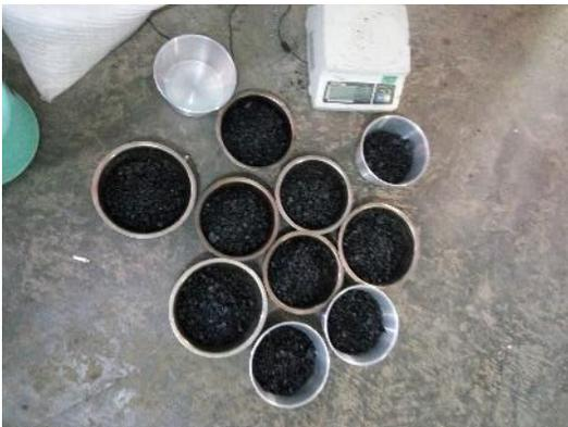
**Gambar 12.** Pengujian hasil *trial mix* campuran beraspal panas di laboratorium penyedia jasa
