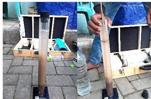
**Gambar 5.** Pengujian Nilai Setara Pasir secara mandiri oleh penyedia jasa
