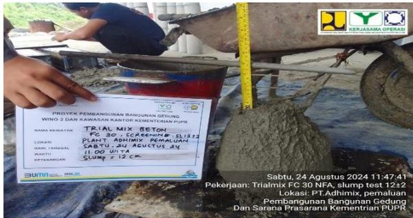
Gambar 9. Slump test
