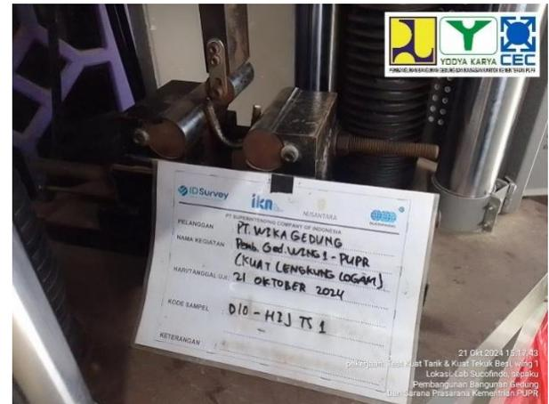
Gambar 12. Test kuat tekuk baja
