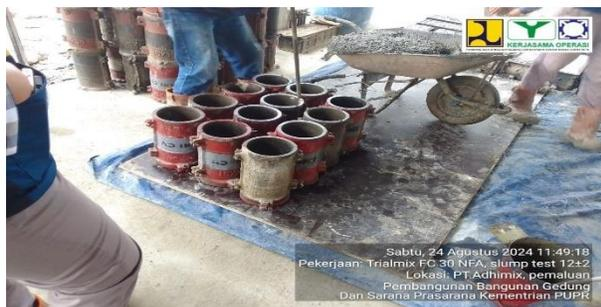
Gambar 10. Pembuatan benda uji
