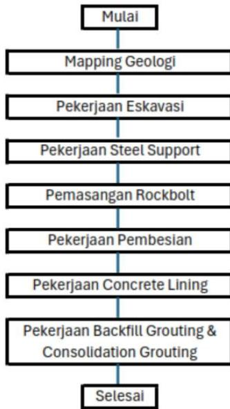
**Gambar 2.** Bagan alir pelaksanaan pekerjaan sipil pada konstruksi *headrace tunnel* PLTA Jatigede 2x55 MW Chainage PT0+907,609 – PT0+967,609
