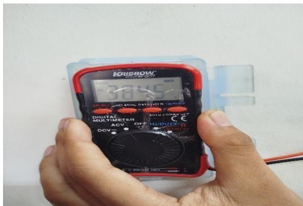
Gambar 9. Pengukuran nilai tegangan
