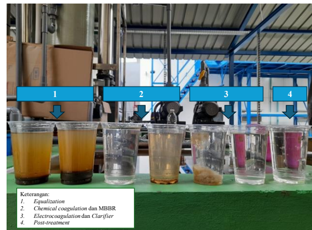
Gambar 8. Hasil operasional WWTP pada proses commissioning air limbah industri XYZ
