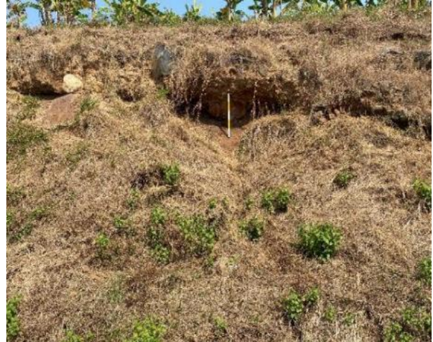
Gambar 10. Fase erosi permukaan lereng tingkat sangat lanjut di mana kestabilan lereng mulai terpengaruhi.
