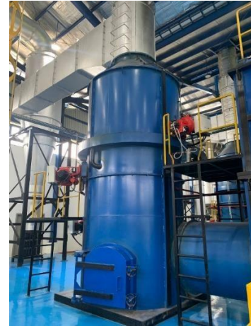
Gambar 4. Proses pembakaran di ruang bakar 2
