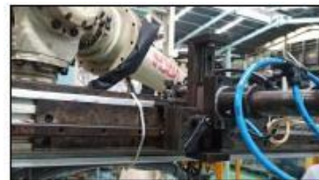
Gambar 4. Arm Robot Handling saat ini Selanjutnya, arm robot handling tersebut diganti dengan aluminium profile 40 x 40 mm, dengan bracket dan ball join vacuum .
