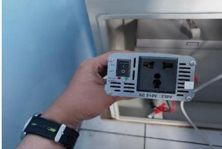
**Gambar 6.** Pemasangan *inverter*
