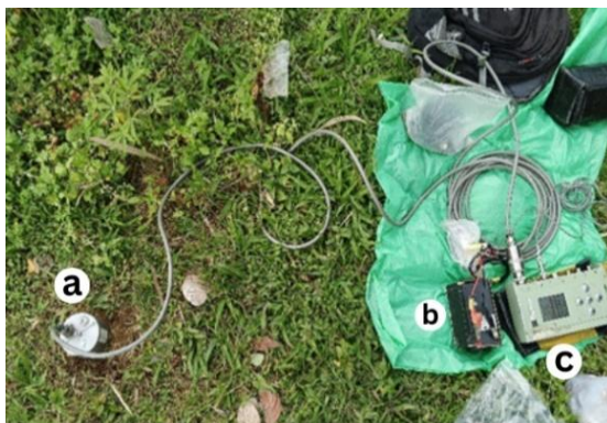
Gambar 4. Proses Pengukuran Data Mikrotremor menggunakan a) seismometer, b) aki, dan c) digitizer
