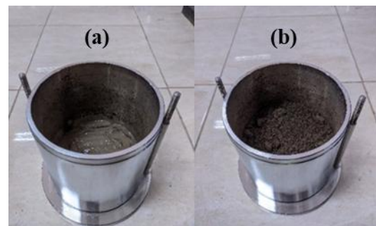
Gambar 2. (a) Sampel lumpur dalam mold ; (b) Sampel tanah dan lumpur dalam mold .
