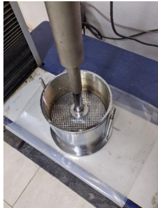
Gambar 3. Uji kuat tekan pada Universal Testing Machine
