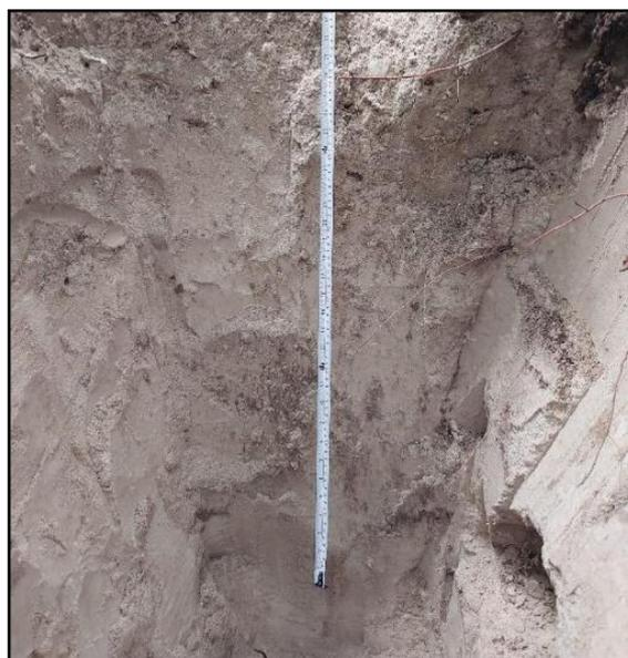
Gambar 2. Sumur Uji untuk pengambilan sampel pasir kuarsa.
