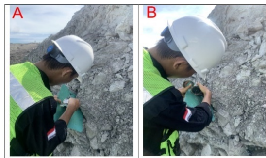
Gambar 10. (A).Pengukuran Strike (B) Dip
