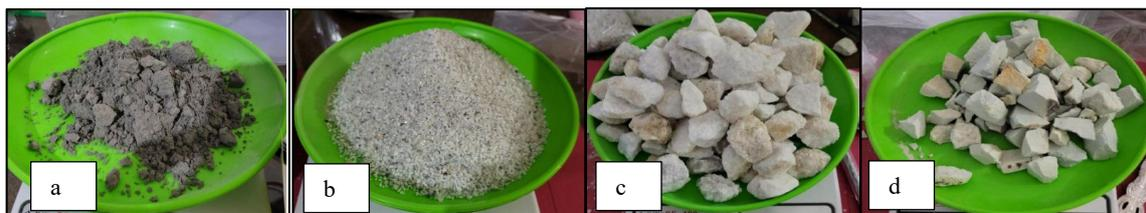
Gambar 3. (a) Fly Ash, (b) Pasir Silika, (c) Batu Kapur, (d) Batu Zeolit
