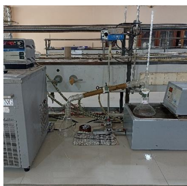
Gambar C.15 Melakukan proses distilasi dengan suhu 75 - 80°C selama 2-3 jam.
