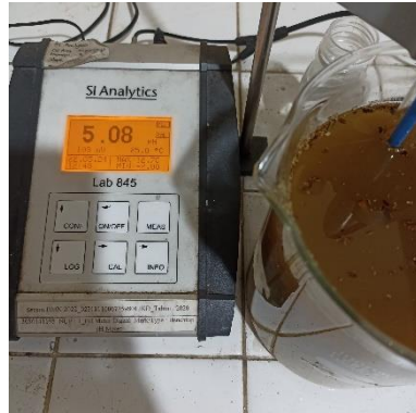
Gambar C.7 Melakukan pengukuran pH mencapai nilai pH 5 dan memasukan enzim selulase 1%.
