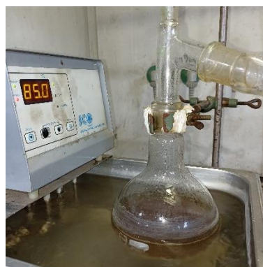
Gambar C.14 Memasukkan sampel hasil fermentasi ke dalam labu distilasi.
