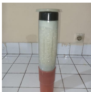
Gambar C.16 Memasukkan bioetanol ke dalam kolom yang berisi adsorben untuk pemurnian/adsorpsi.
