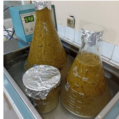
Gambar C.8 Memanaskan sampel dengan waterbath dengan suhu 60°C.
