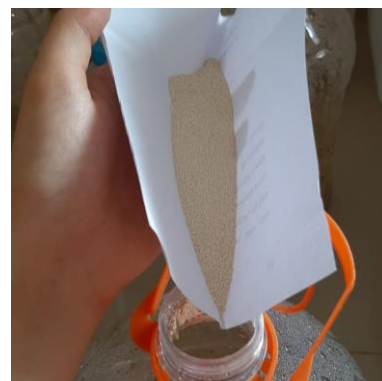
Gambar C.11 Menambahkan ragi dengan konsentrasi 4% ke dalam larutan hidrolit dan masing-masing Urea dan NPK dengan konsentrasi 0,5% sebagai nutrient.
