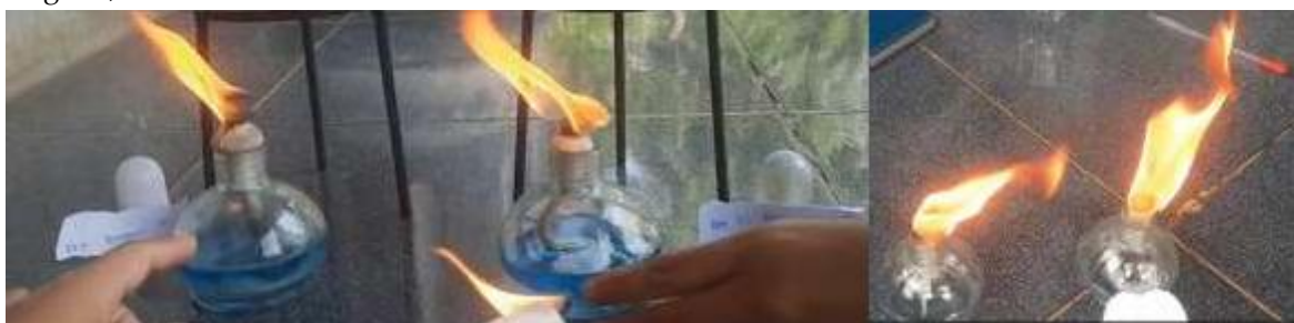
Gambar 1. Uji Nyala Api Bahan Bakar dari kiri ke kanan pertamax, beras ketan putih, beras biasa, nira aren.
