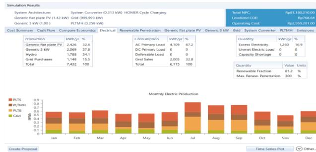
**Gambar 9.** Produksi tenaga listrik tahunan dengan komponen lengkap
