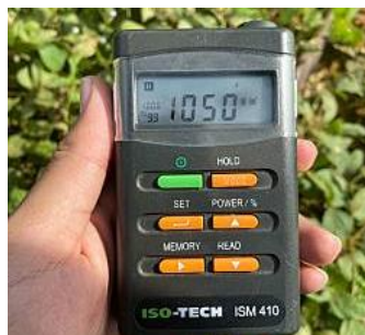
Gambar 2. Pengukuran radiasi matahari di lokasi pemasangan PLTS.
