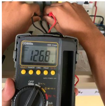
Gambar 10. Pengujian tegangan open circuit PLTS.
