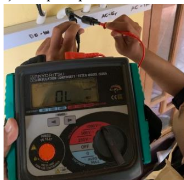
Gambar 8. Pengujian sambungan kabel positif dan negatif
