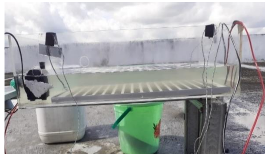
Gambar 8 Panel Surya Dengan Pendinginan
