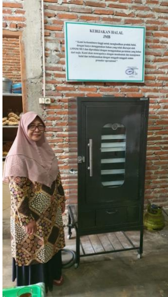
Gambar 2. Teknologi Pengering Rengginang menggunakan Tray Dryer
