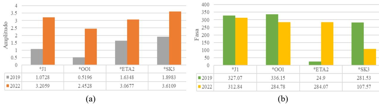
**Gambar 6.** Diagram perbandingan nilai amplitudo komponen signifikan pasang surut (a); Diagram perbandingan nilai fasa komponen signifikan pasang surut (b)
