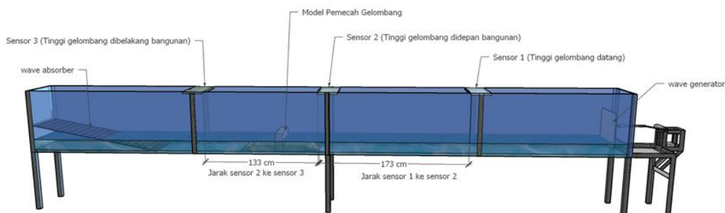
Gambar 3. Pengambilan data pada wave flume
