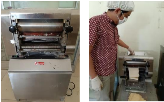
(a) (b) Gambar 2. Roller Press dengan Pencetak Mie (a) dan Penggunaan Roller Press dengan Pencetak Mie (b)
