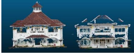
**Gambar 4.** Sebelah kiri *point cloud drone*. Sebelah kanan *point cloud kamera mirrorless*.
