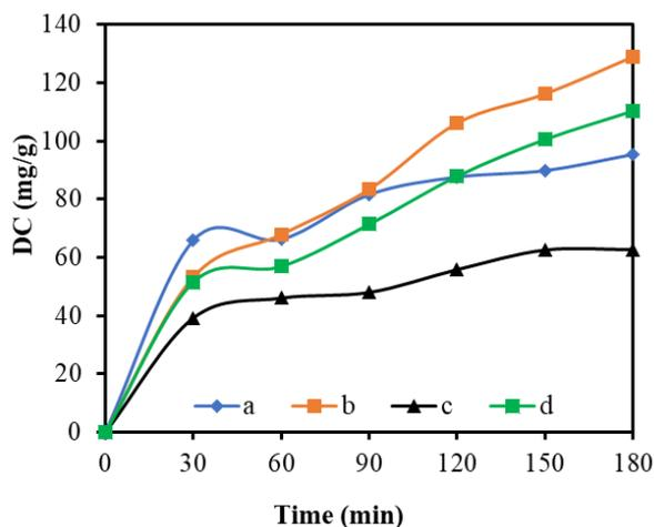
Figure 12. Degradation capacity of Cr-PTC-HI<sub>na</sub> in (a) MB; (b) MB+ $H_2O_2$  0.2M; (c) MB+ $CH_3OH$  0.2M; and (d) MB+ $H_2O_2$  0.2M + tert-butanol 0.2M.
